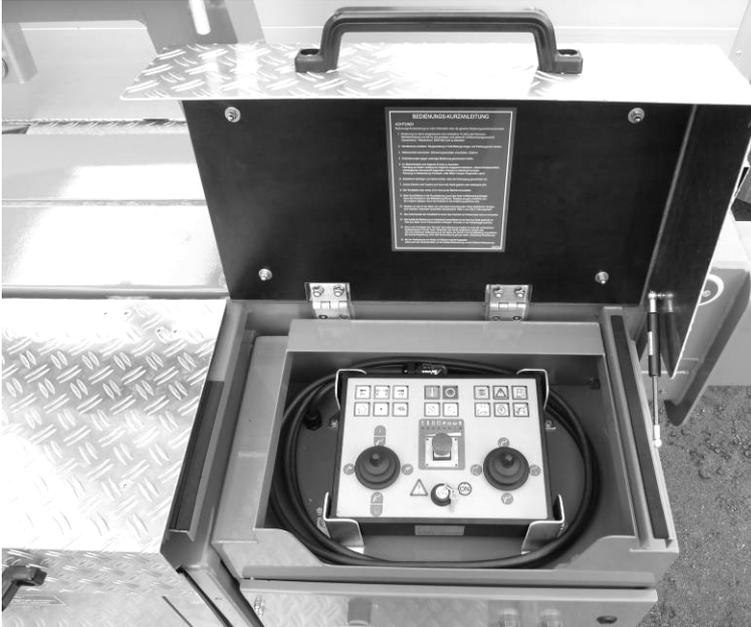
Das Bedienpult für die Zweitsteuerung / Notbedienung besteht aus folgenden Komponenten:
