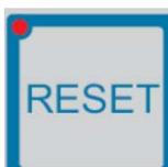
Mit der Taste *RESET* (>3s gedrückt), wird die komplette Steuerung zurückgesetzt
