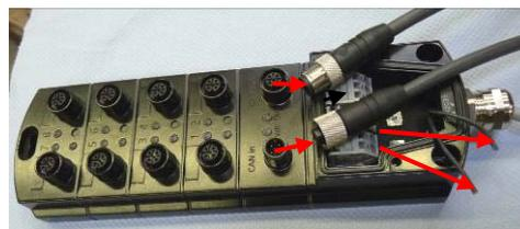
d) Abziehen der Kompakt-Stecker am/im Korb-Steuerpult
