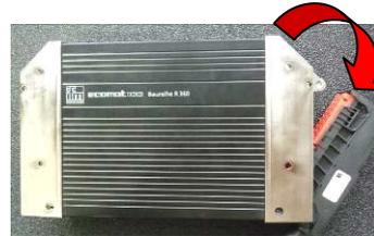
c) Abziehen der M12-Stecker und Abklemmen der Stromversorgung an den I/O-Knoten
