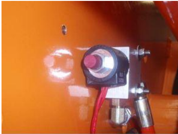
Notbedienung des Zusatzventils im hydraulischen Kreis des oberen Trägers Abb. 5-5-A und 5-5-B
