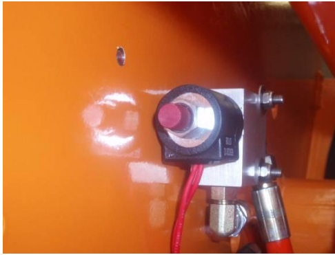
Notbedienung des Zusatzventils im hydraulischen Kreis des oberen Trägers Abb. 5-10-A und 5-10-B
