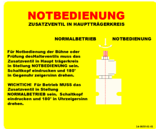
Notbedienung des Zusatzventils im hydraulischen Kreis des oberen Trägers Abb. 5-5-A und 5-5-B
