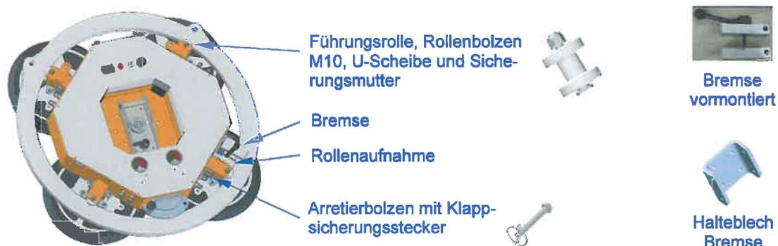
Abb. 15: Montage des Führungsringes
