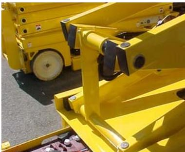
Die Wartungsstütze ermöglicht das gefahrlose Arbeiten unter der Maschine.
