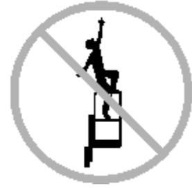
Steigen Sie nicht von der Plattform, solange sie angehoben ist. Wenn die Stromversorgung ausfällt, fordern Sie das Bodenpersonal auf, das Ventil zum manuellen Senken zu aktivieren.
