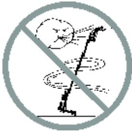
Nehmen Sie die Maschine bei starkem oder böigem Wind nicht in Betrieb. Die Fläche der Plattform oder der Ladung darf nicht vergrößert werden. Wenn die dem Wind ausgesetzte Fläche vergrößert wird, wird die Stabilität der Maschine beeinträchtigt.
