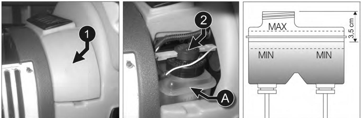
Auf dem Display "S1" der Steuereinheit MERlin befindet sich die Anzeige (95), die das Sinken des Ölstands der Bremsen und des Gaspedals unter den Mindeststand "MIN" angibt. In diesem Fall muss die Maschine so schnell wie möglich gestoppt werden und:
