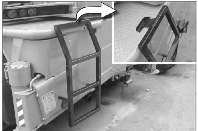
Nach dem Gebrauch die Zusatzleiter wieder im hinteren rechten Teil des Maschinenrahmens unterbringen und mit der Halterung "B" und der Flügelmutter "A" befestigen.
