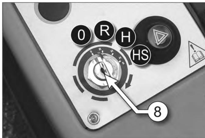
Bei Temperaturen unter 0° C ist zum Starten des Motors der Einsatz des Thermostarters erforderlich:
