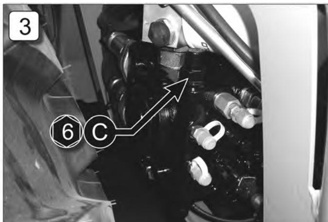
Nach dem Auffüllen ist es erforderlich, die Luft aus der Anlage abzulassen. Dazu die folgenden Anweisungen beachten:
