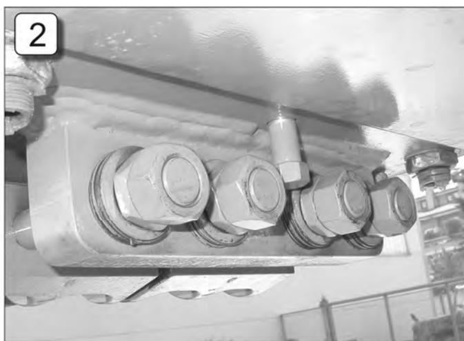
Den Teleskoparm vollkommen ausfahren und parallel zum Boden positionieren. Den Abstand zwischen den Ketten und der unteren Oberfläche zwischen dem ersten und dritten Ausleger messen (die Messung muss auf der Hälfte der Kettenlänge erfolgen).
