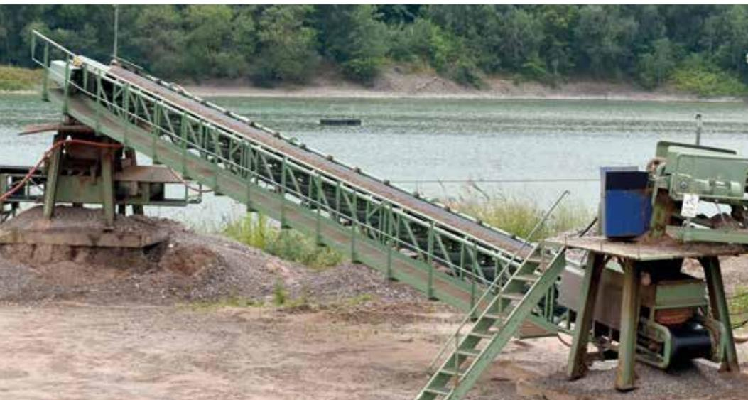
**BEWEGLICH:** Um die erforderliche Flexibilität zu erfüllen, wurde die Zulaufseite der frei tragenden Konstruktion auf einem massiven Betonfundament abgesetzt.
