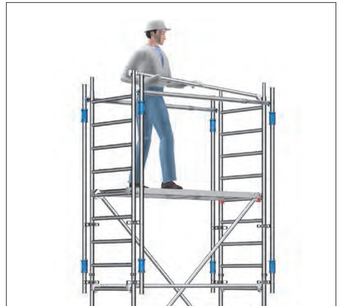
Bild 6: Sichere Montage der Rückenlehnen mit MSG
