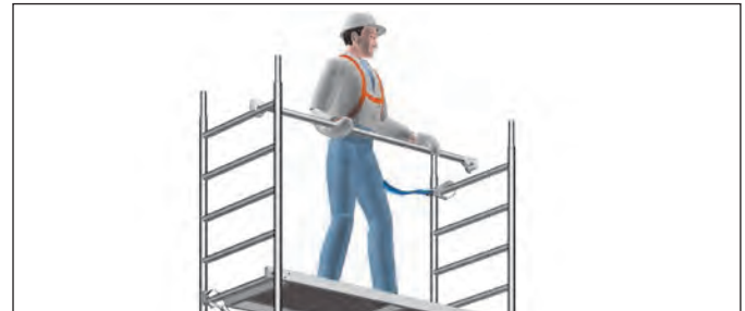
Bild 3: Sichere Montage der Rückenlehnen mit PSA
